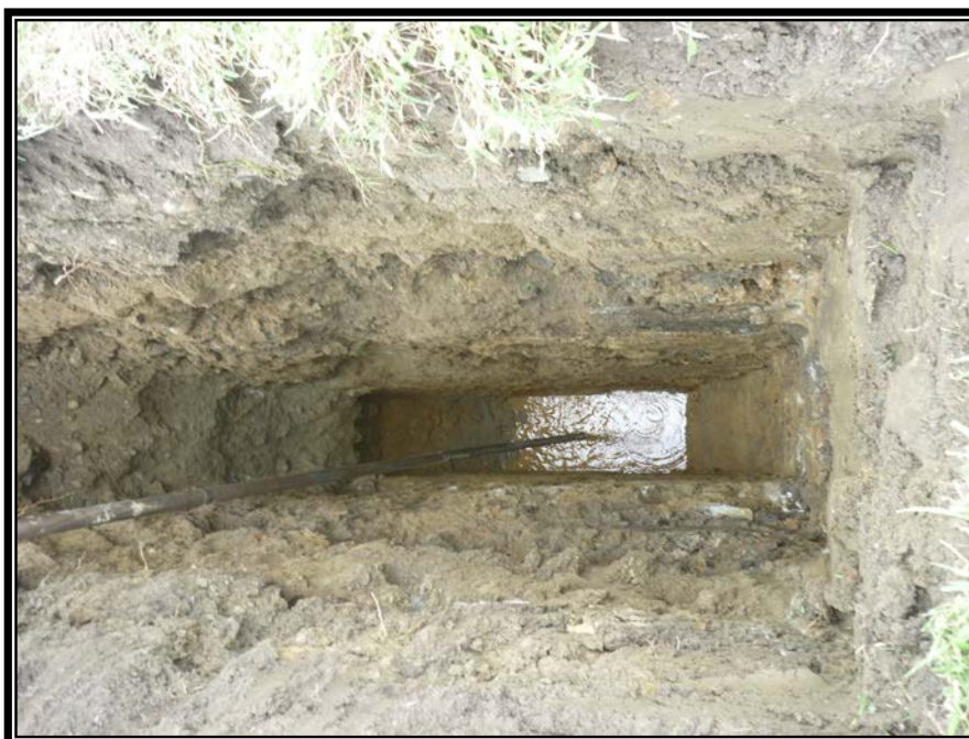
PRESENCIA DE NIVEL FREÁTICO A 4 M EN LA CALICATA Nº 9 FOTO Nº 20
