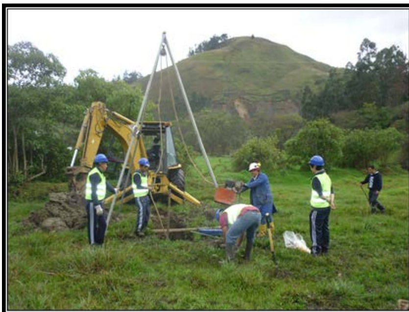
PENETRACIÓN ESTÁNDAR EN LA CALICATA Nº 13 - FOTO Nº 28 PRESENCIA DEL NIVEL FREÁTICO A 1.0 METRO.
