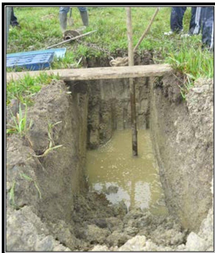
PENETRACIÓN ESTÁNDAR EN LA CALICATA Nº 13 - FOTO Nº 28 PRESENCIA DEL NIVEL FREÁTICO A 1.0 METRO.
