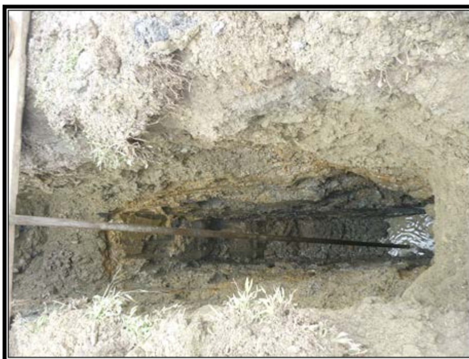
MATERIALES GRANULARES A LA PROFUNDIDAD DE 4M EN LA CALICATA N° 6 - FOTO N° 14
