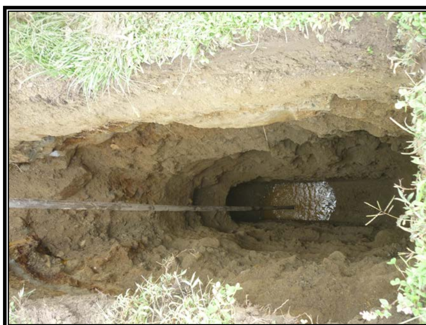
PRESENCIA DE NIVEL FREÁTICO A 4 M EN LA CALICATA Nº 11 - FOTO Nº 24
