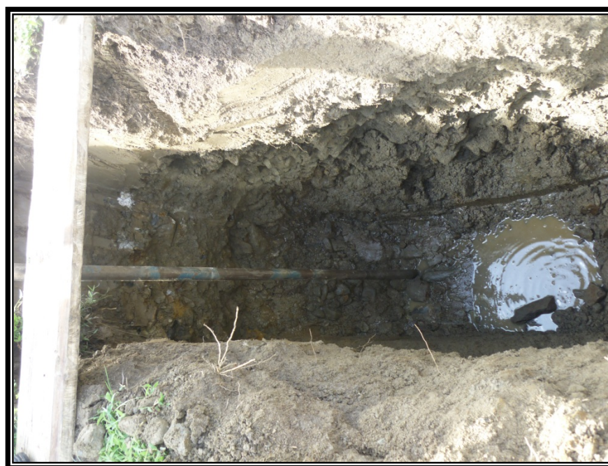
MATERIAL GRANULAR, PRESENCIA DE NIVEL FREÁTICO A 1,7 M EN LA CALICATA Nº 3 FOTO - Nº 8
