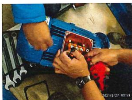
Limpieza de humedad motores eléctricos
