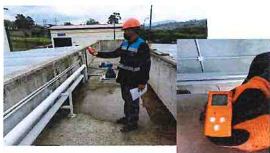
MEDICIÓN DE ATMÓSFERAS PELIGROSAS CON EL DETECTOR MULTIGAS CON LABORATORIO ACREDITADO
