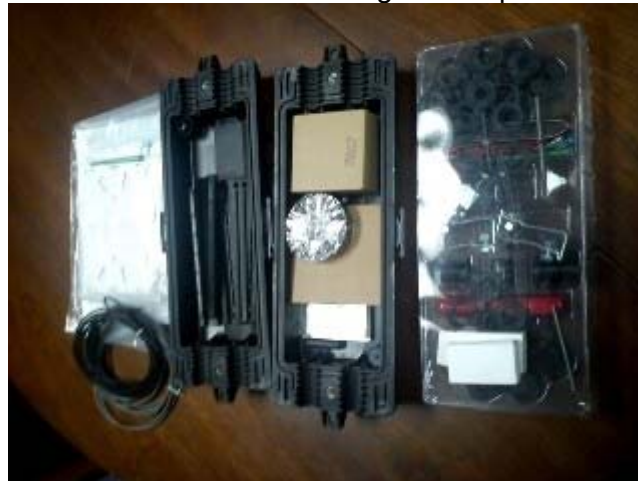
b. Vista interior de manga de empalme.
