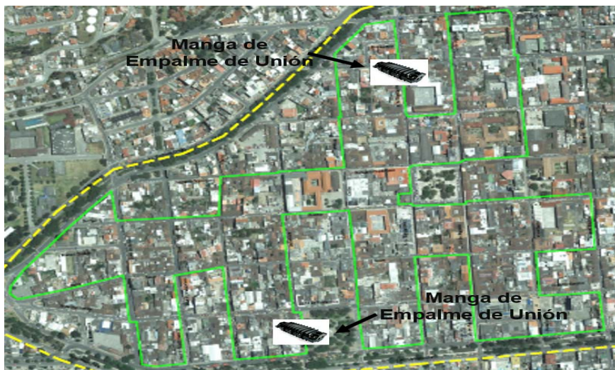
Fig. 13. Mangas de empalme para continuidad del anillo uno.
