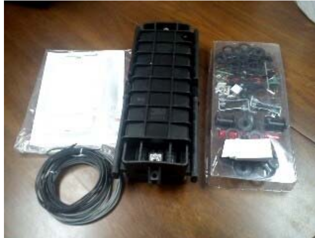
a. Vista exterior de manga de empalme.
