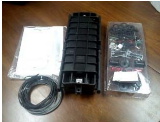
a. Vista exterior de manga de empalme.
