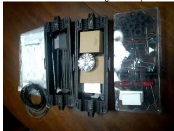
b. Vista interior de manga de empalme.
