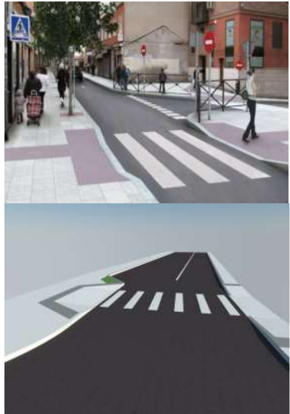
FOTO 21: Oreja de estacionamiento y rampas modelo 3d.
