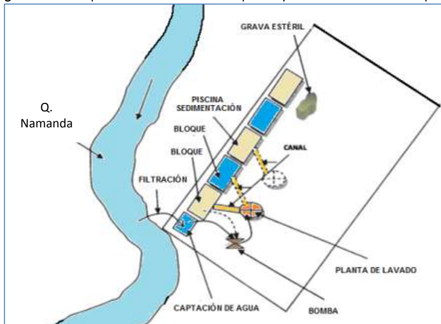
Imagen 5. Proceso para obtención de material pétreo y control de sólidos en suspensión
